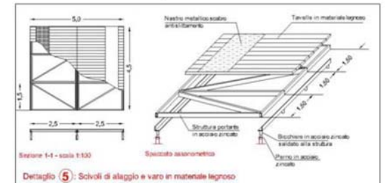
Dettaglio (5) - Scivoli di alloggio e varo in materiale legnoso
